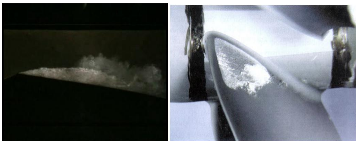
Figure 2.3. Cavitation à poche partielle [22]
