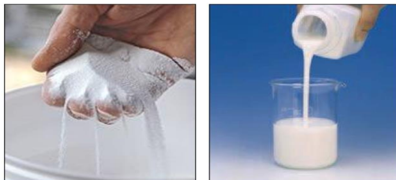
Fig. 18- Exemple des MCP micro-encapsulés : à l'état poudre et à l'état liquide.
