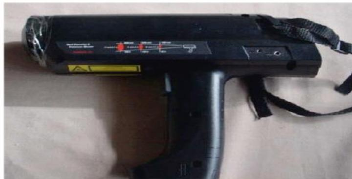
Figure 2.11- Pyromètre à infrarouge [24]
