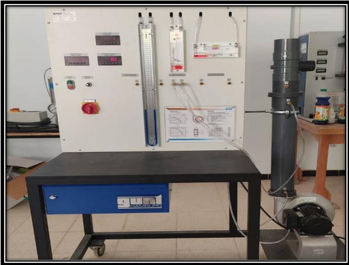
**Figure 3.1** Banc d'essai d'un ventilateur radial
