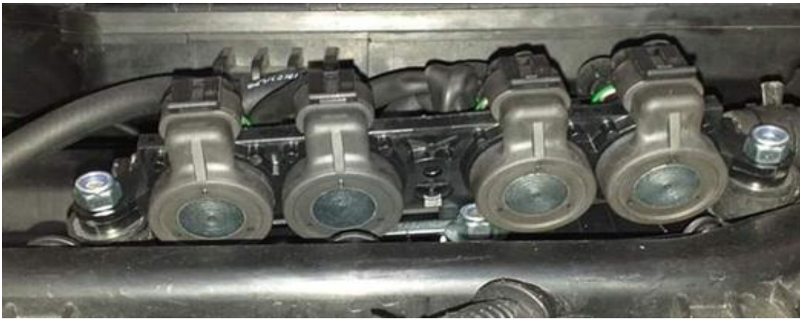
Figure 12 : La Rampe D'injecteurs
