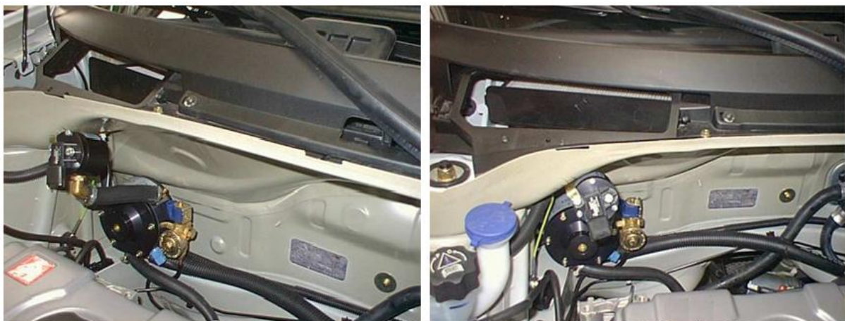
Figure 16: Montage du filtre GPL
