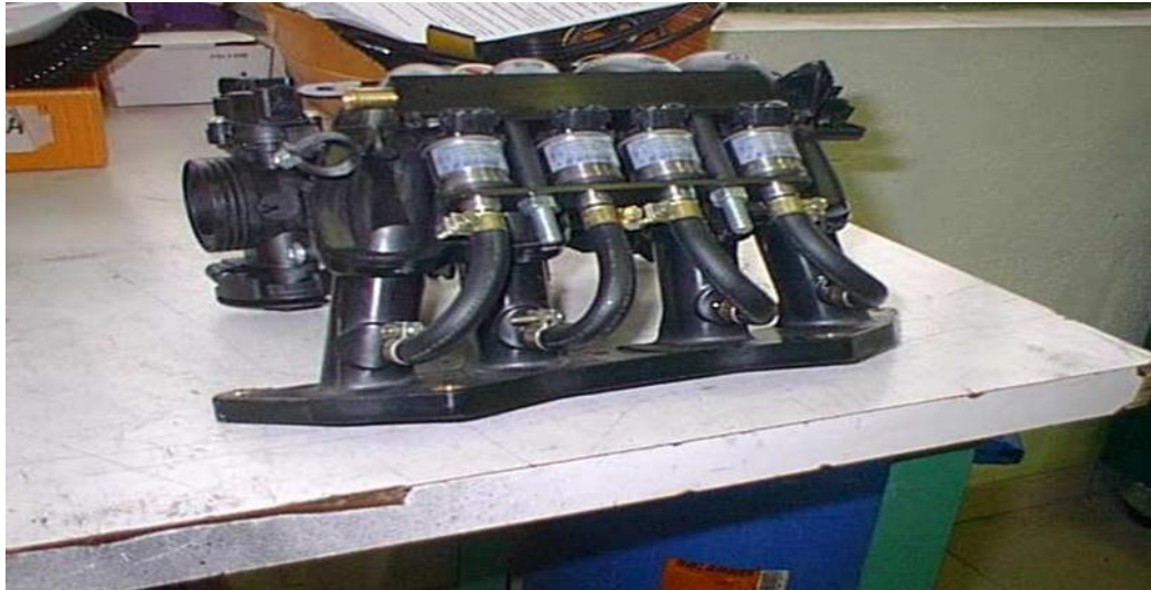
Figure 15 : Montage des buses d'injection sur les collecteurs d'admission
