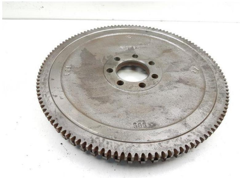
**Fig. 12- Volant moteur rigide [11]**
