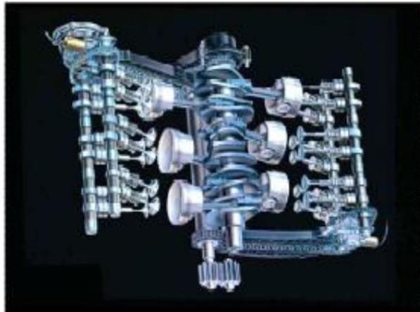
Fig. 8- Moteur à cylindres opposées. [3]
