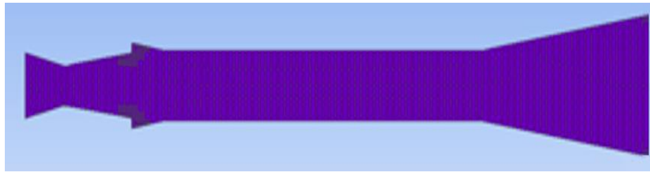
Fig. 22 - Maillage structurée de l'éjecteur (deuxieme cas)
