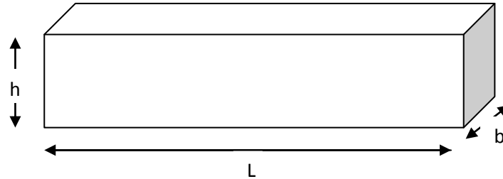
Figure. II.8 : Dimensions d'une poutre.
