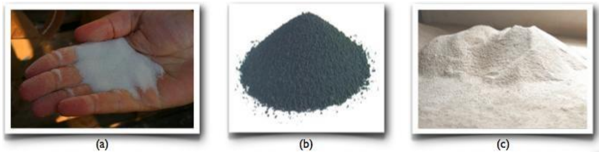
Figure I.21. Exemples des charges : (a) microbilles de verre, (b) noir de carbone, (c) silice.
