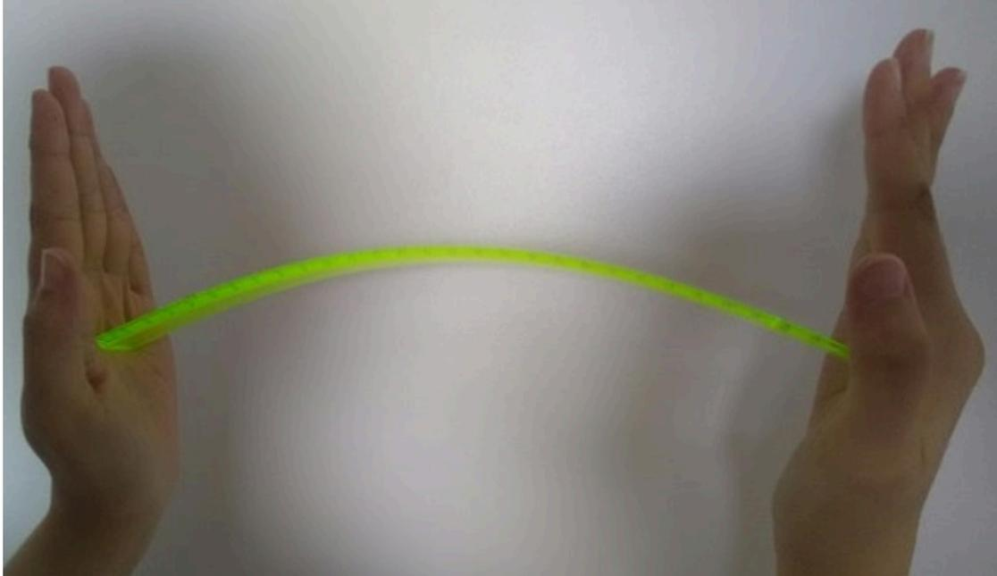
**Figure.I.3:** *Flambement associé à deux forces de compression.*
