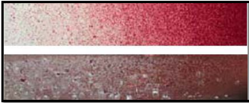
Figure .I.17 : En haut: texture en fibre de verre avec des éléments de silicium à perméabilité graduelle; En bas: essai de l'étanchéité à l'eau, source: ILEK
