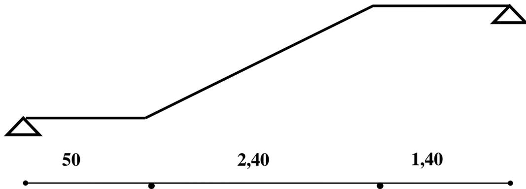
Figure III.5: Schéma statique de l'escalier
