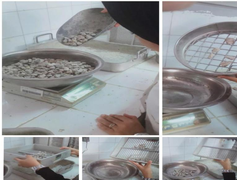
**Figure II.VII : coefficient d’aplatissement**
