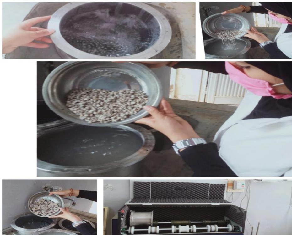
**Figure II.IX :l’essai de micro deval an présence d’eau**
