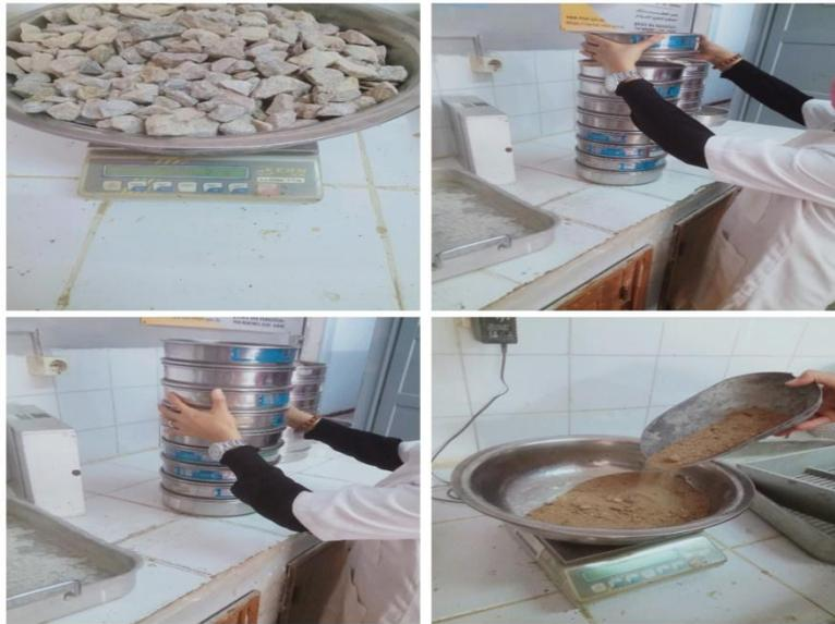
**Figure II.1 : analyse granulométrique par tamisage**
