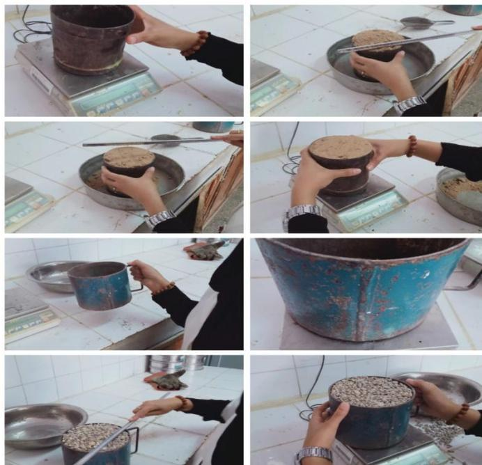
**Figure II.IV : essai de masse volumique**
