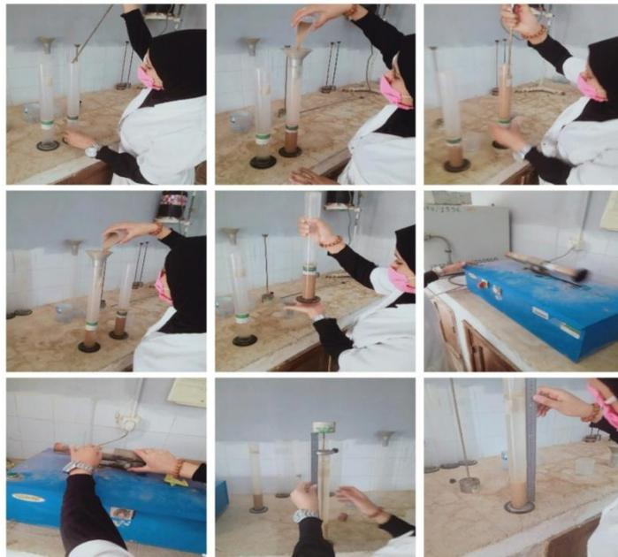
**Figure II.VI: essai équivalent de sable**
