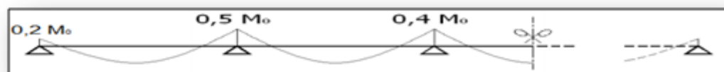
Figure III.3: Les valeurs absolues des moments sur appuis sont évaluées selon le nombre des travées
