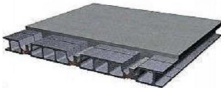
Figure I.6 : Plancher à corps creux.
