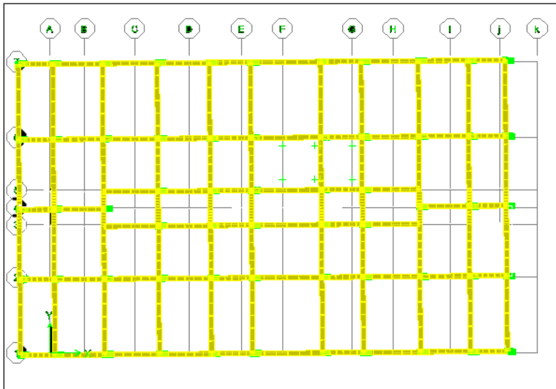
Figure V.4 : Première mode ( T=0,581 sec) principal de vibration suivant X
