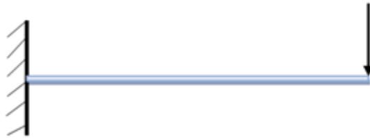
Figure II. 3 : cas d'une poutre console.
