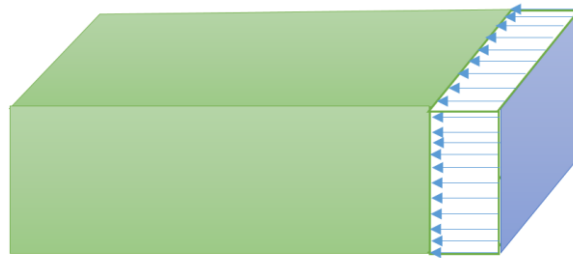
Figure II. 11 : la distribution des contraintes de cisaillement à travers l'épaisseur dans le cas de la théorie de premier ordre.
