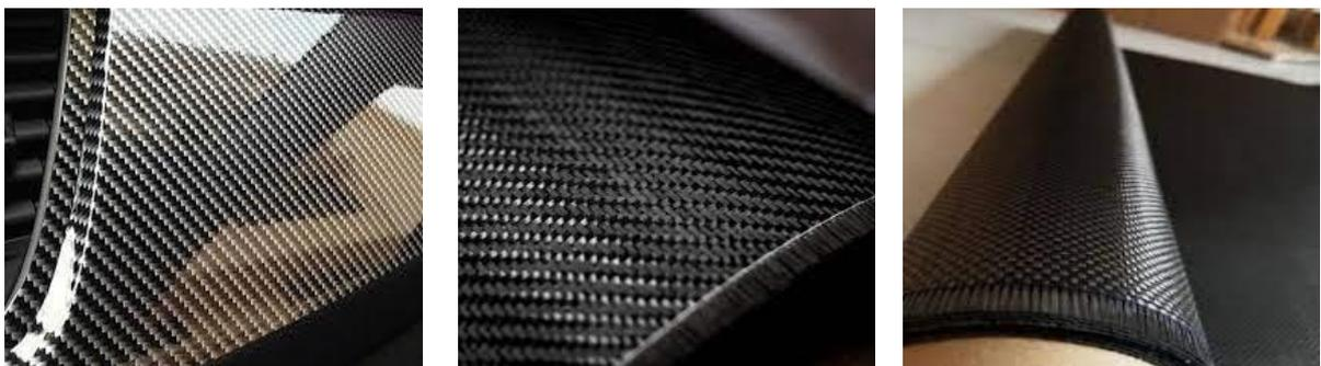
**Figure 2.4 :** Tissu de fibres de carbone (TFC).
