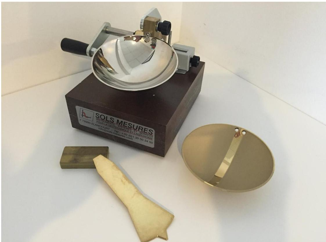
FIGURE 21- APPAREIL DE CASAGRANDE
