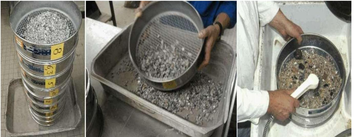
L'essai consiste à peser un poids ( $P$ ) de l'échantillon de sol à l'aide d'une balance, et on place la série de tamis de haut en bas par celui ayant la grande ouverture vers la plus petite, on verse l'échantillon du sol dans le premier tamis (celui de grande ouverture), et on place la série de tamis dans la colonne de la tamiseuse, on laisse tamiser pendant dix minutes.
