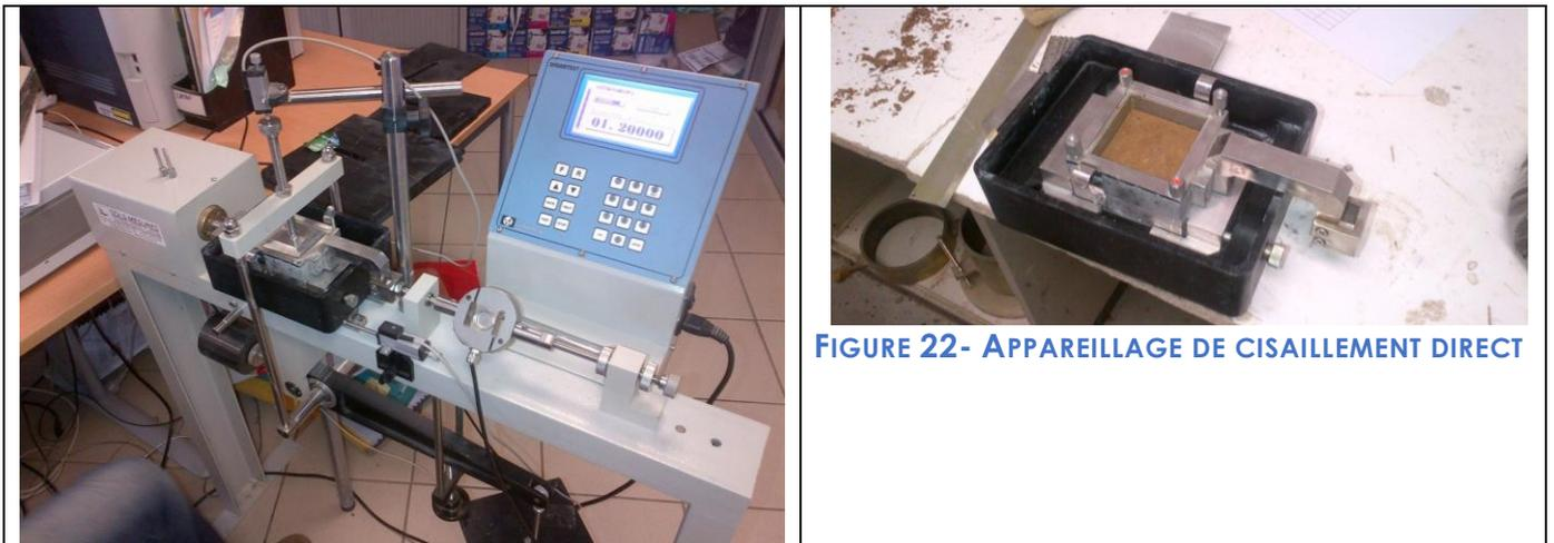
FIGURE 22- APPAREILLAGE DE CISAILLEMENT DIRECT
