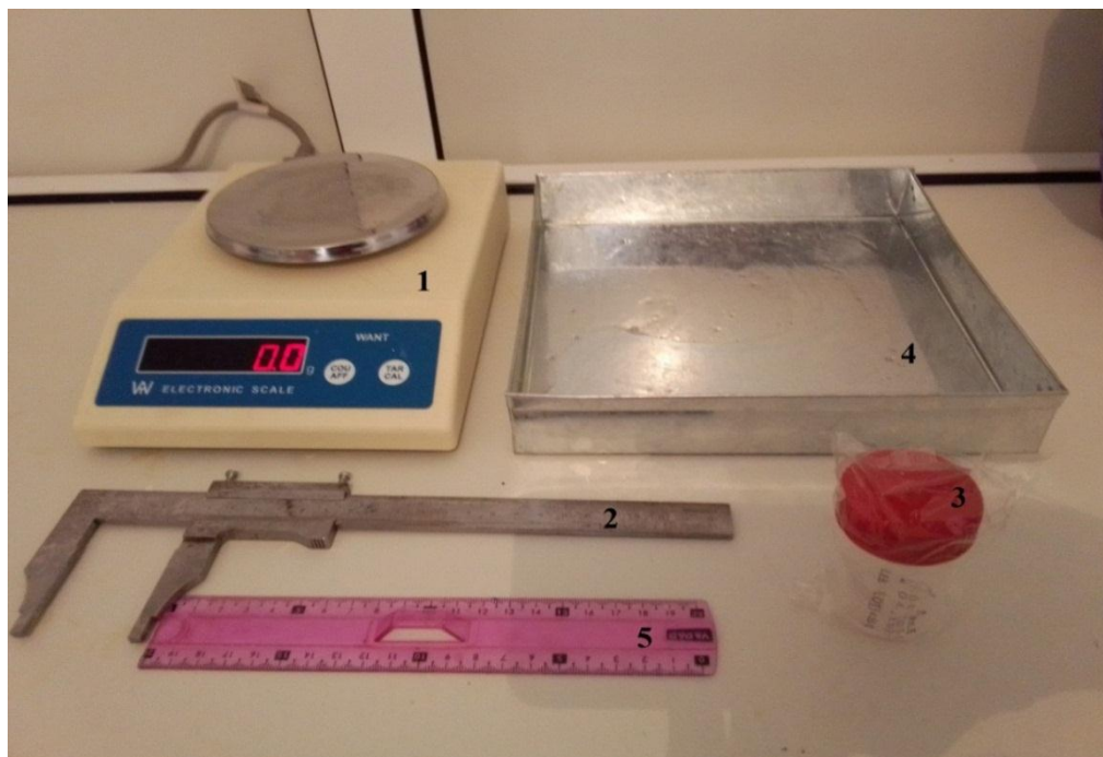
Figure IV.18 : Matériels utilisés pour l'étude des paramètres morpho-pondéraux des œufs (1-Balance, 2- Pied à coulisse, 3- Boîte de prélèvement, 4- Plateau en inox, 5- Règle en plastique).
