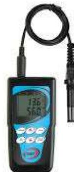
**Figure 11:** Thermo hygromètre
