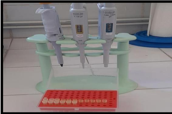
**Figure N°03: Micropipette automatique
