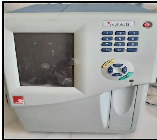
Figure N°11 : automate d'hématologie (MYTHIC 18) (ISV)
