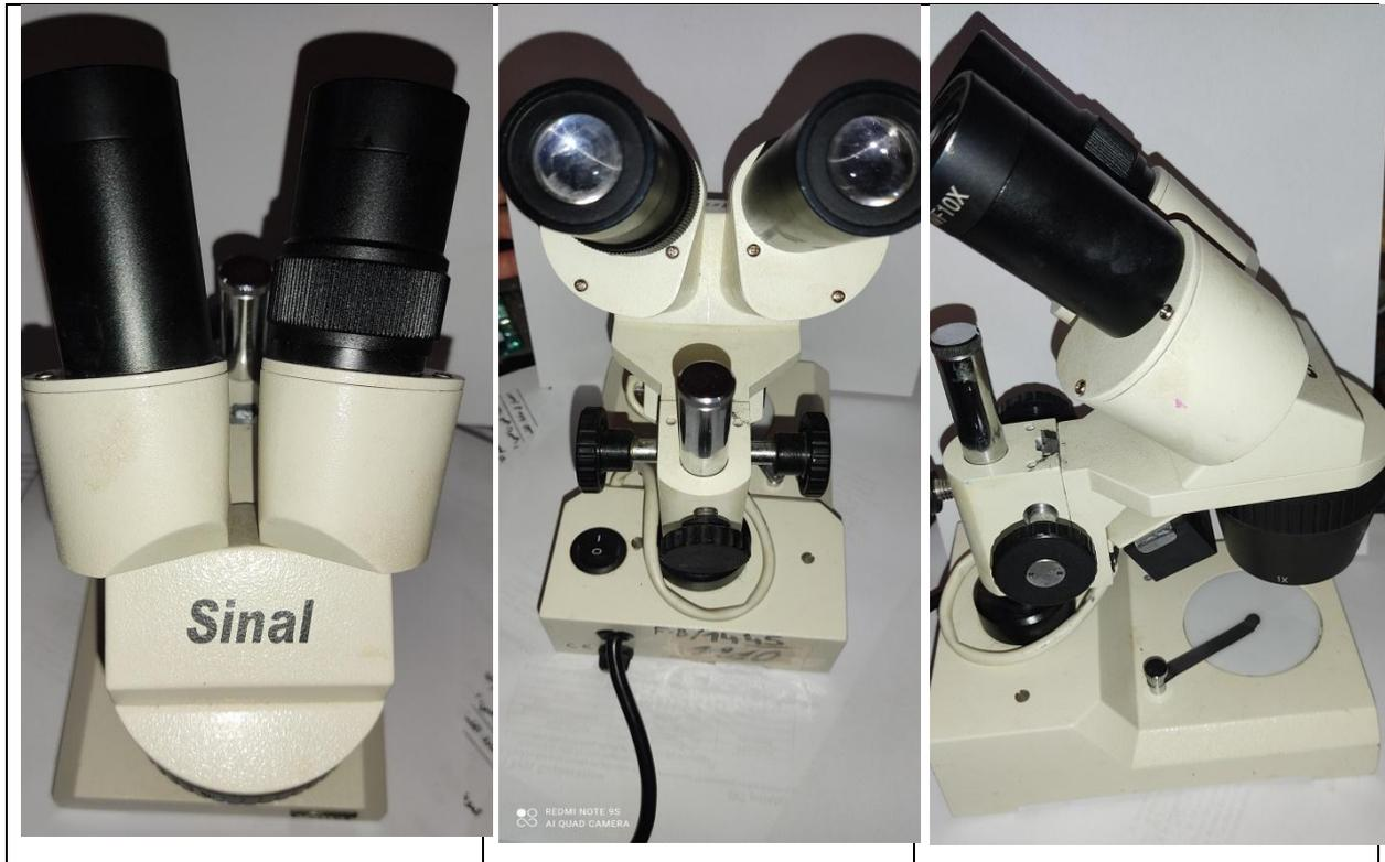
**Figure27** : loupe binoculaire (photo originale,2021)
