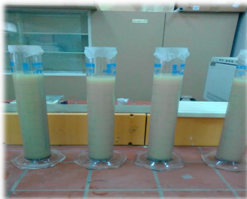
Figure III.2 –Représentation de la montmorillonite en suspension.
