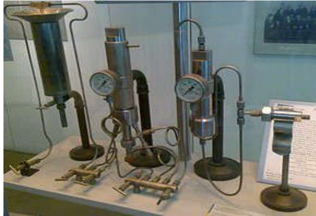
Figure III. 01 : Appareil de laboratoire utilisé par Fritz Haber pour synthétiser de l'ammoniac en 1909[27].
