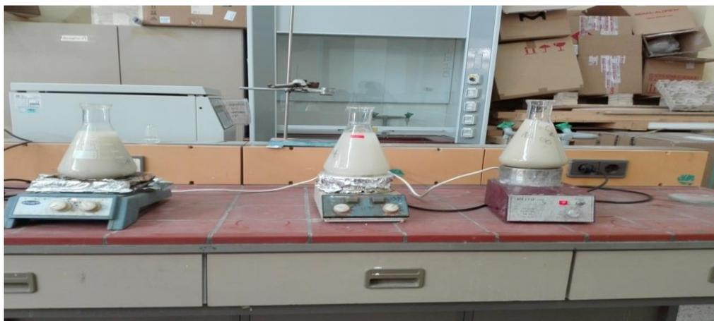
**Figure IV. 3 : la mode de purification de la bentonite naturelle.**
