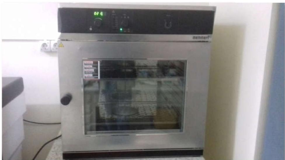
**Figure IV. 4 :** Etuve utilisée pour le séchage des membranes.
