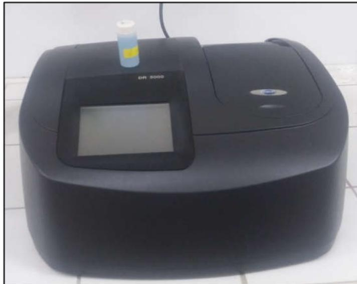
**Figure IV. 16 :** Spectrophotomètre UV-Visible HACH DR 5000
