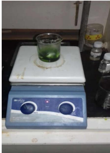
**Figure IV. 1 :** Photo montre la préparation du gel.
