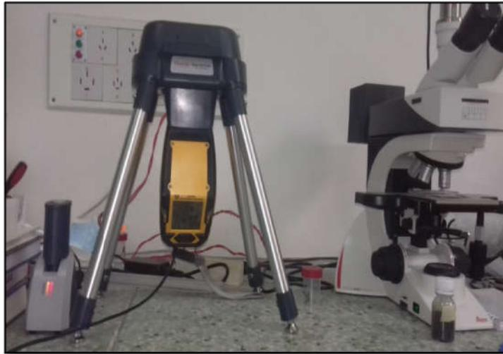
Figure IV. 13 : Spectromètre portable XRF utilisé
