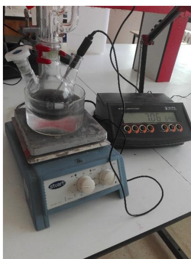
Figure III.8 : Photo de réaction de transestérification hétérogène
