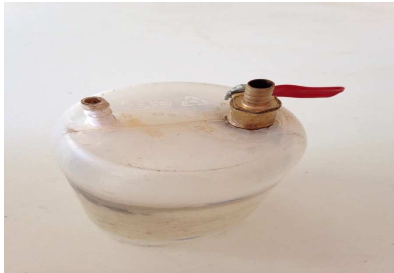
Figure IV-5 : Un pot en plastic avec un robinet pour le contrôler le gaz
