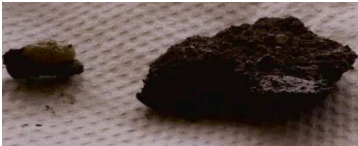
Figure III-7 : Résidus solides présent dans le réacteur à la fin de la réaction de la Manipulation 05
