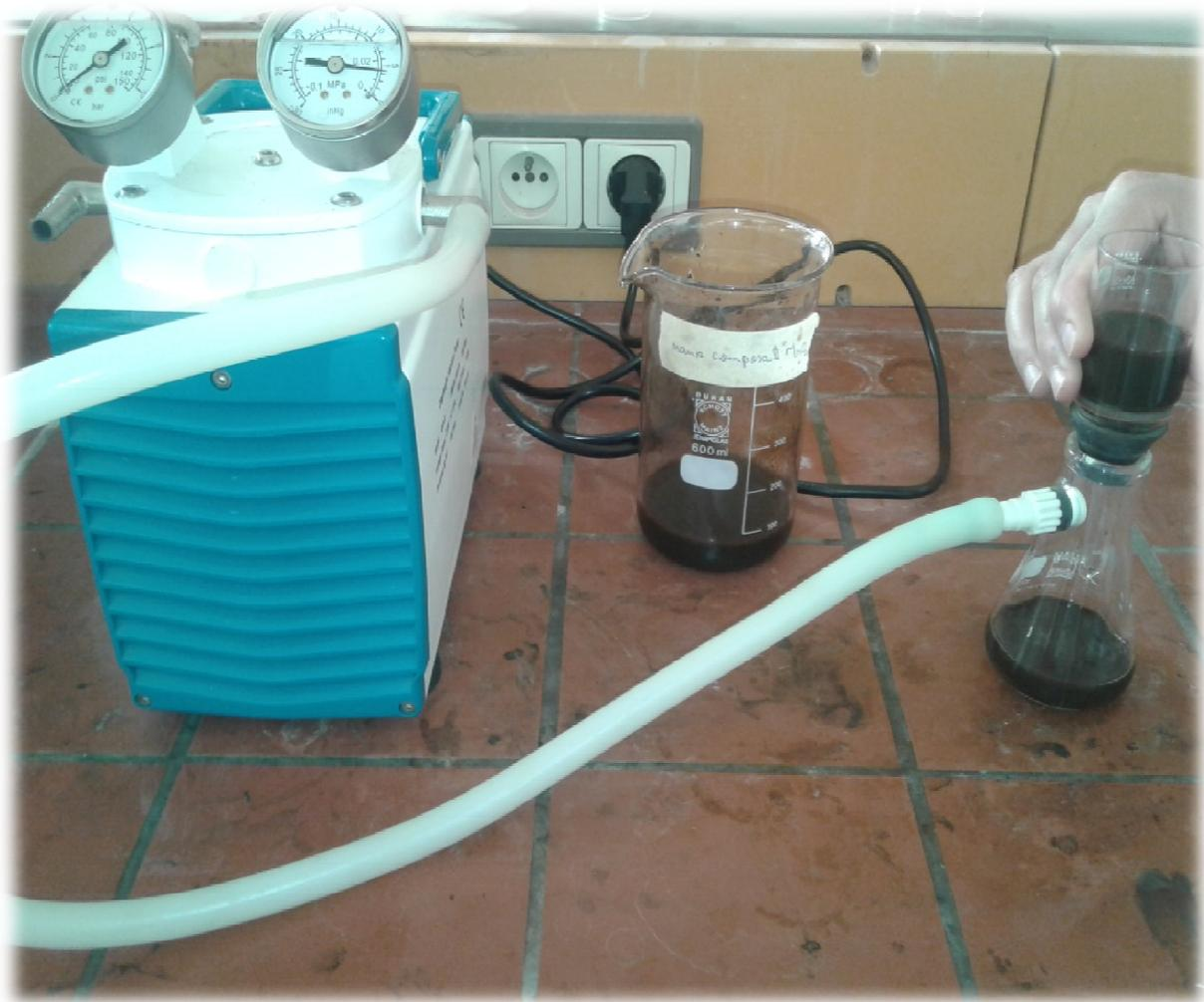
**Figure III.12. Filtration de solution (nano-composant + liquide ioniques)**
