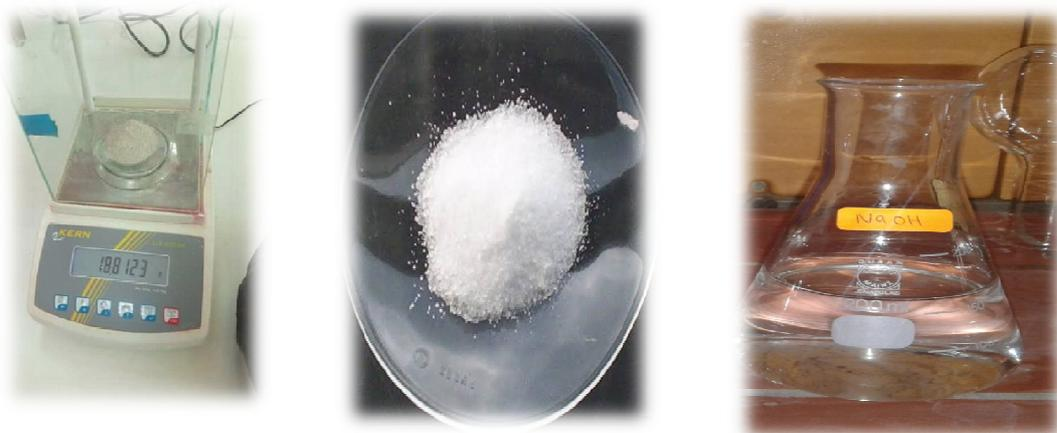
Figure III.2. Préparation de l'hydroxyde de sodium (NaOH)
