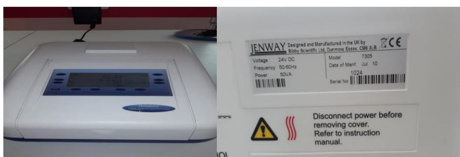
**Figure IV.5 :** Le spectrophotomètre UV-Visible.
