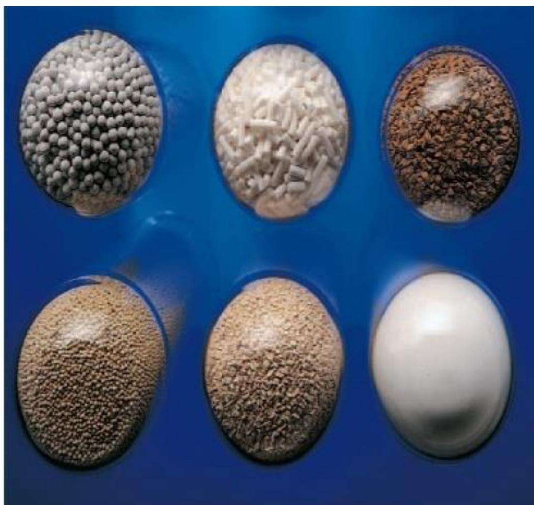
**Figure III-10** : différentes formes des tamis moléculaire
