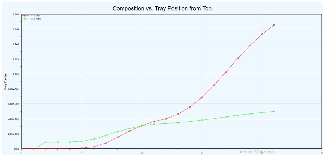
Figure V.6 : Profil de fraction molaire du CO 2 obtenu par HYSYS du cas design de C001
