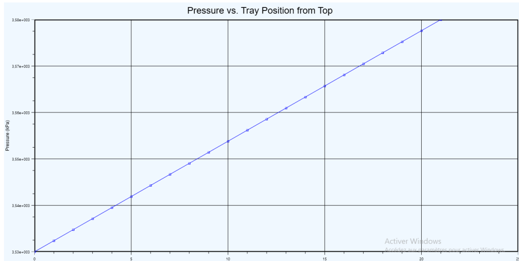
Figure V.9 : Profil de pression obtenu par HYSYS du cas actuel de C001.
