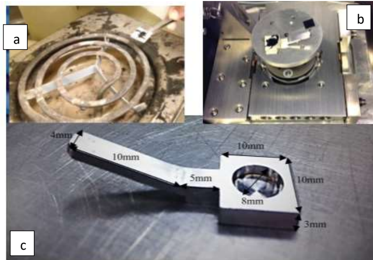
Fig.1.8- (a)Procédure d'échauffement (b) Porte échantillon d'un MEBE (C) Mouled'échantillon
