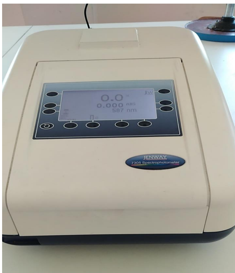
Figure IV.3 Un spectrophotomètre JENWAY 7305
