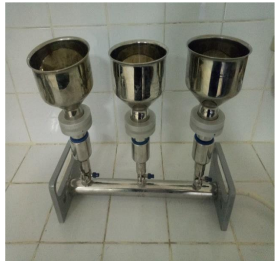
Fig N° IV.6 : Rampe de filtration
