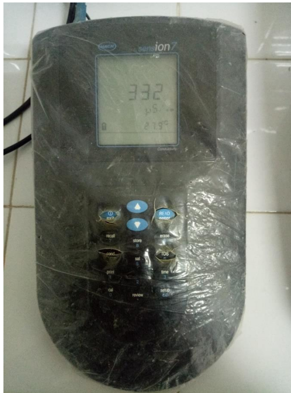
Fig N° IV.2 : Conductimètre, mesurer la conductivité, TDS et salinité.
