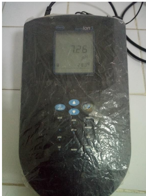
Fig N° IV.1 : PH Mètre, mesurer le PH et température en °C.
