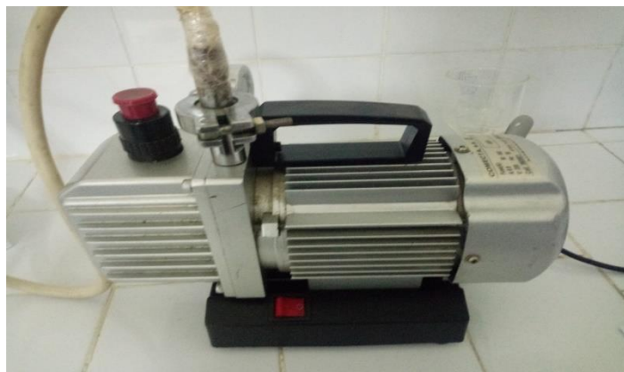
Fig N° IV.7: pompe à vide
