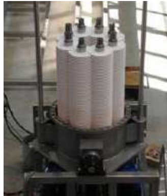
Figure I.22 : Module MSD industriel avec huit arbres parallèles et les disques membranaires de 31 cm de diamètre (Westfalia Separator) [47]
