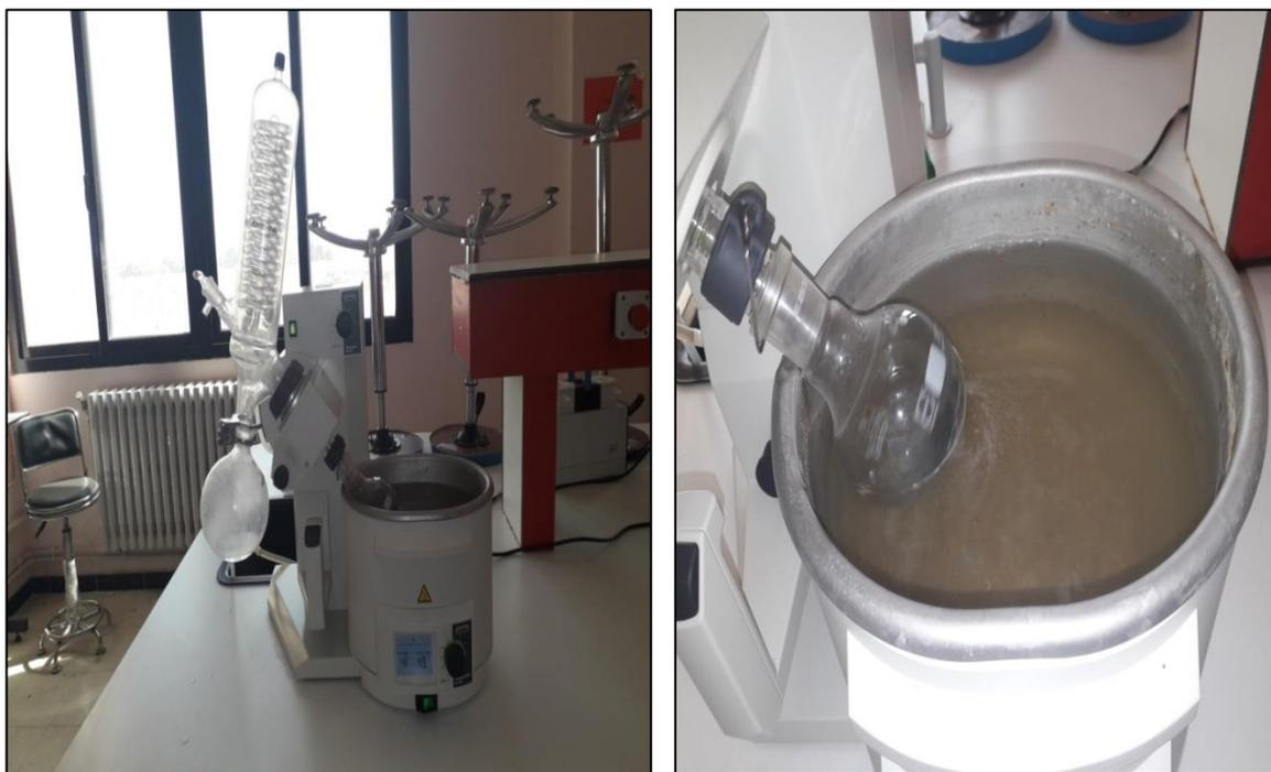
Figure IV.17 : Photographie représente la distillation par évaporateur rotatif.
