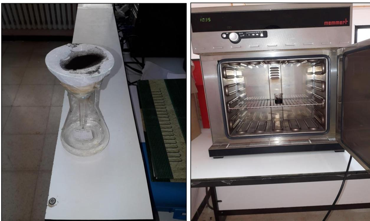
Figure IV 11 : Photographie représentatif de la filtration et le séchage du CuO.
