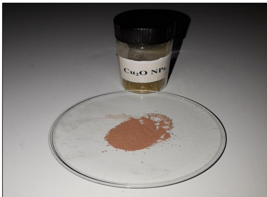
**Figure IV.8 : Photographie représentatif de la poudre du  $\text{Cu}_2\text{O}$  .**
