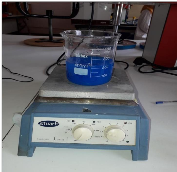
**Figure IV.3 : Photographie représentatif de l'agitation du  $\text{CuSO}_4$  et NaOH.**
