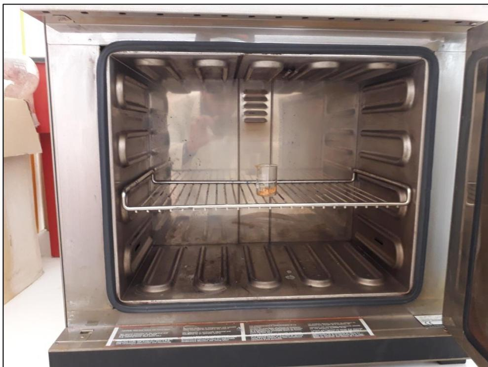
**Figure IV.6 : Photographie représentatif du séchage par l'étuve.**
