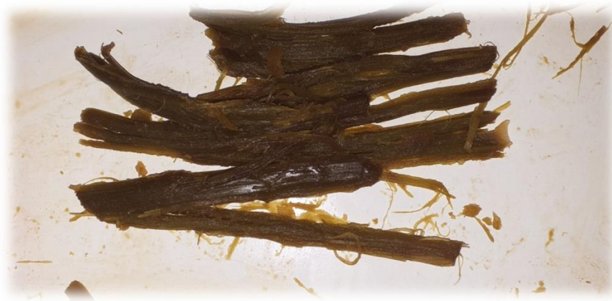
Figure. III.14 : Les tiges d'artichaut durant l'extraction des fibres.
