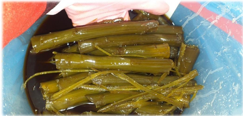
Figure. III.13 : Les tiges d'artichaut après 15 jours du repos dans Une solution de (NaOH-H 2 O (distillée)).
