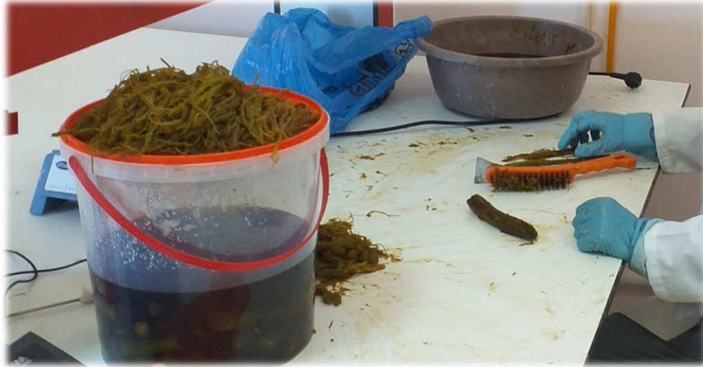
Figure. III.11 : L'extraction mécanique des fibres (brosse métallique).
