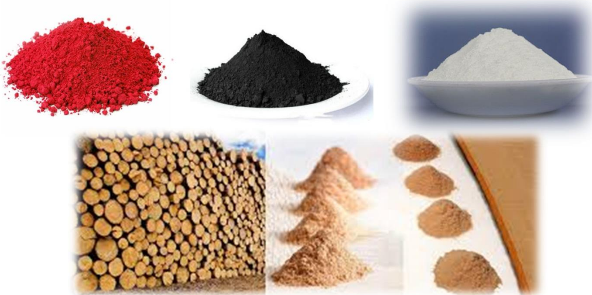
Figure. II.16 : Les charges (poudre de brique, poudre de nickel, poudre de cellulose, farine du bois).
