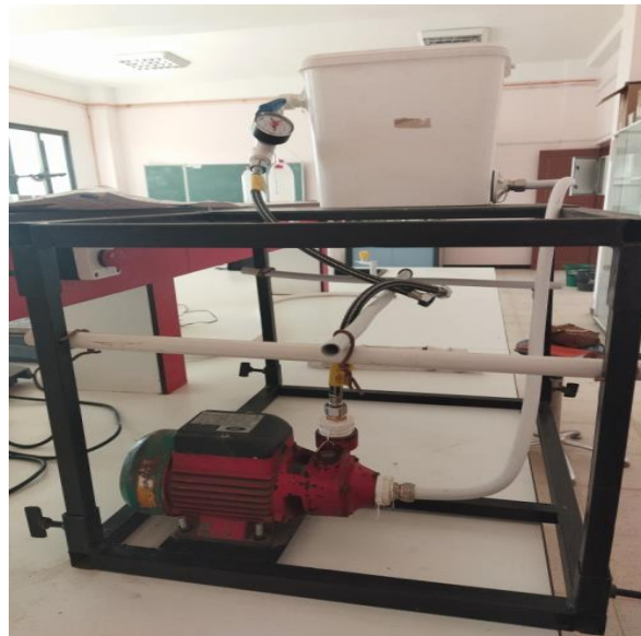
Figure IV.17 : Pilote de filtration
