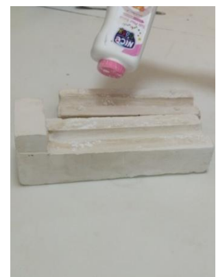
Figure IV.8 : photos représentant l'outil de moulage des membranes
