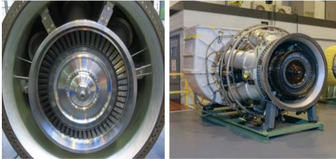
Figure III.13: Caisse turbine du compresseur (HP)
