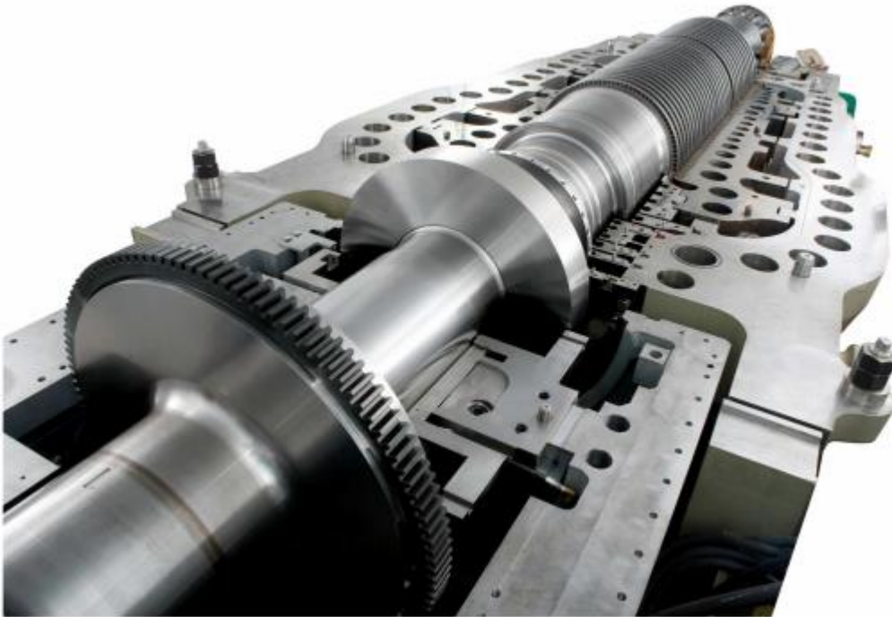
Figure II .4 : la turbine à vapeur
