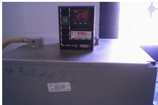
Figure IV.1: Bain thermostatique pour maintenir les produits à la température de 25 °C
