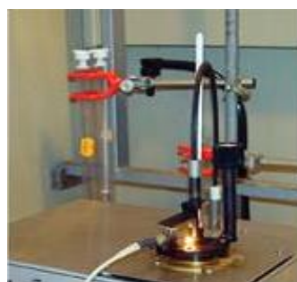
Figure IV.5: Appareillage de mesure du point de flash.
