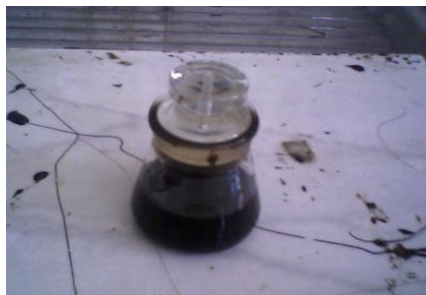
Figure IV.7 : Pycnomètre rempli à moitié du produit
