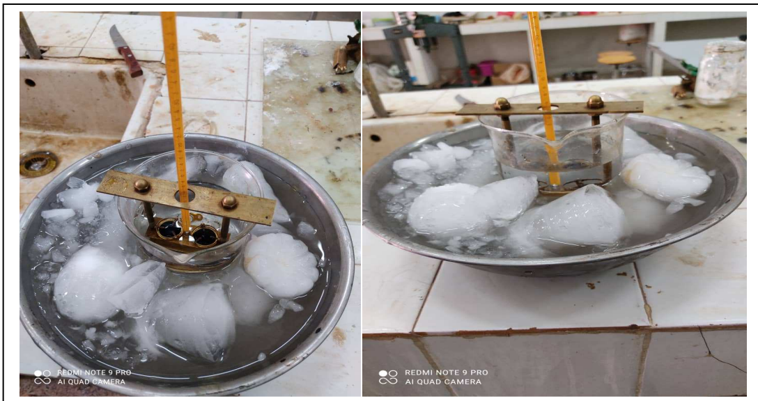
Figure VI.8. Refroidissement de l'échantillon en utilisant la glace fondante.
