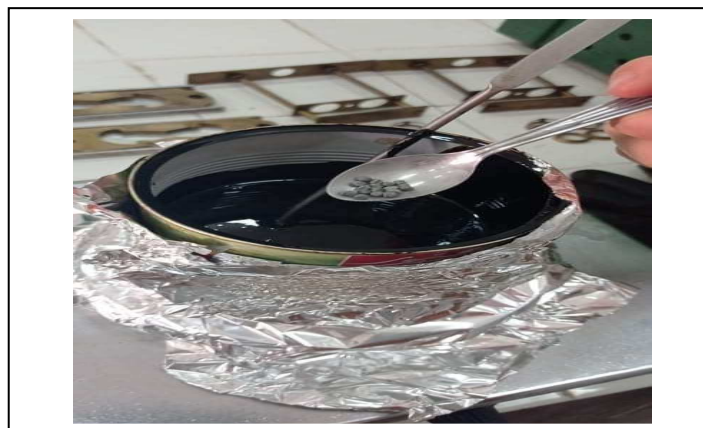
Figure VI.5 . mélange bitume/ Prplaste
