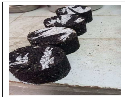
Figure VI.17. Les essais Marshall
