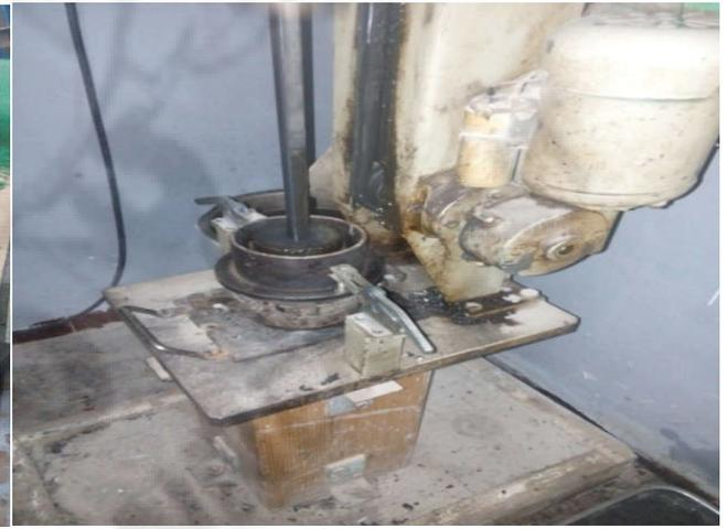
Figure III-6- compacté le mélange à 50N on deux phases.
