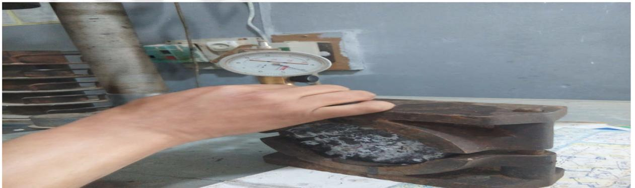
Figure III-8- l'écrasement de mélange et lire l'aisées marshal.
