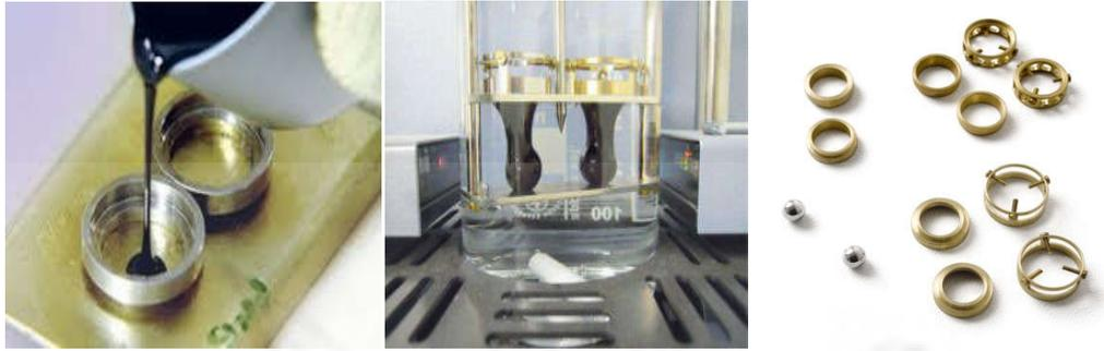
Fig.12-l'appareille de ramollissement.
