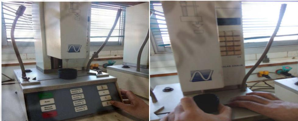
Fig.13-l'appareille de pénétration.
