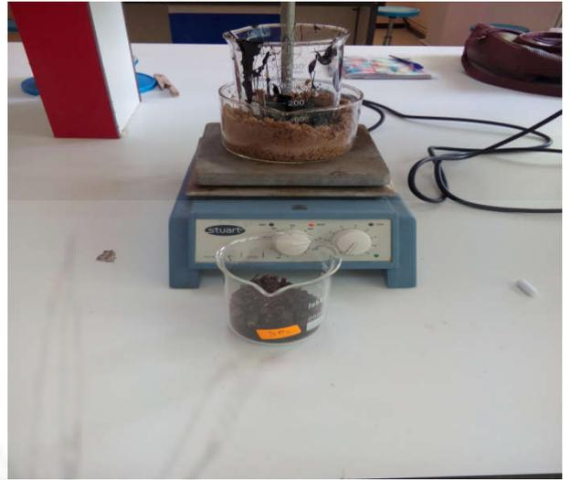
**Figure II-2**-bitume dessus de la plaque chauffage.
