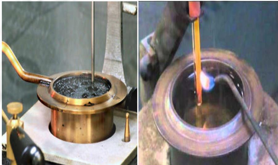
Fig.15-l'appareille de point de flashe.
