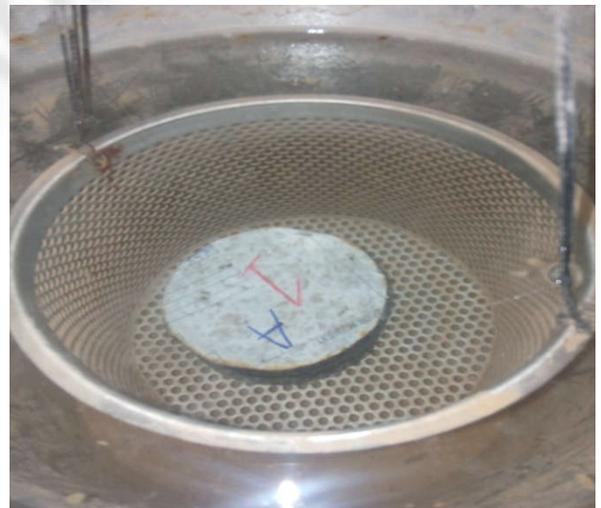
Figure III-6-mesure la densité de chaque gâché.
