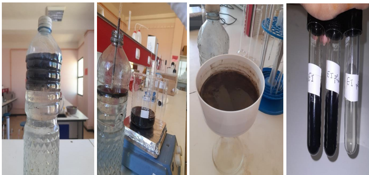
Figure III. 11 : Séparation de la phase aqueuse et organique de l'effluent
