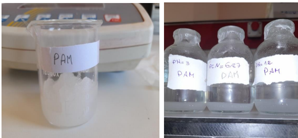
Figure III.7 : Aspect visuel du G-PAM gonflé à pH=3 ; pH= PCN et pH=12.
