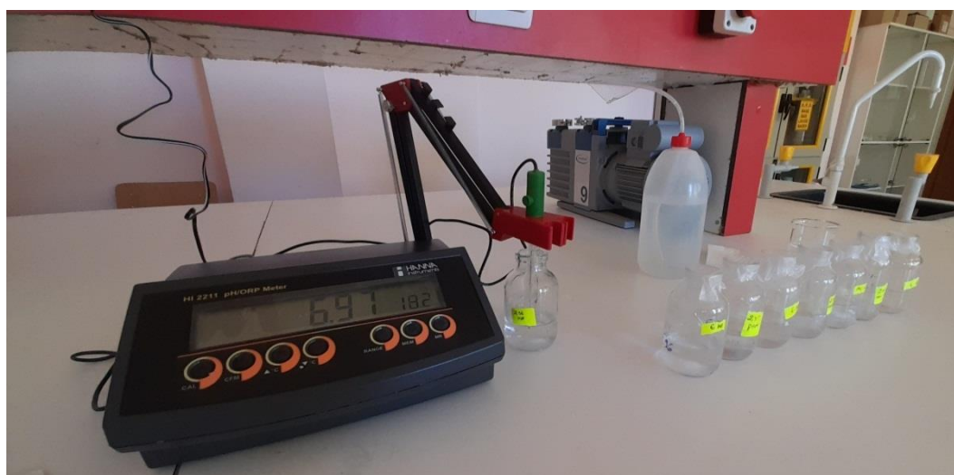
Figure II.16 : Ajustement de pH pour PCN par le pH-mètre
