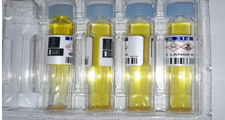
Figure. II.21 : kits mesure DCO : LCK 314 15-150 ppm/LCK 114 150-1000 ppm
