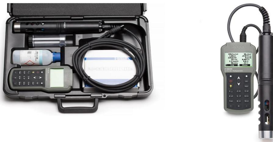
Figure IV -4 : Valisette de terrains multi paramètres.
