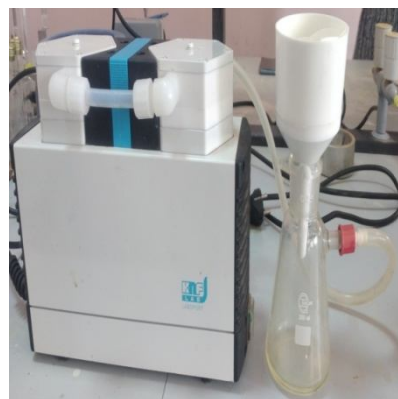
Fig. 13 – Filtration sous vide de HFU
