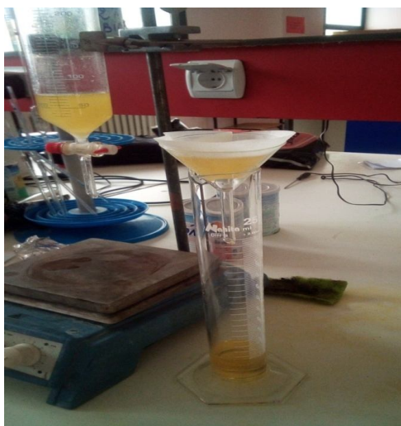
Fig. 19 – Filtration du biodiesel
