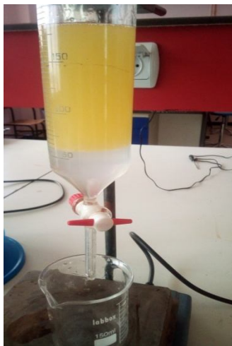
Fig. 17 – lavage de biodiesel
