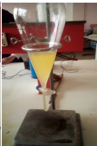
Fig. 17 – lavage de biodiesel
