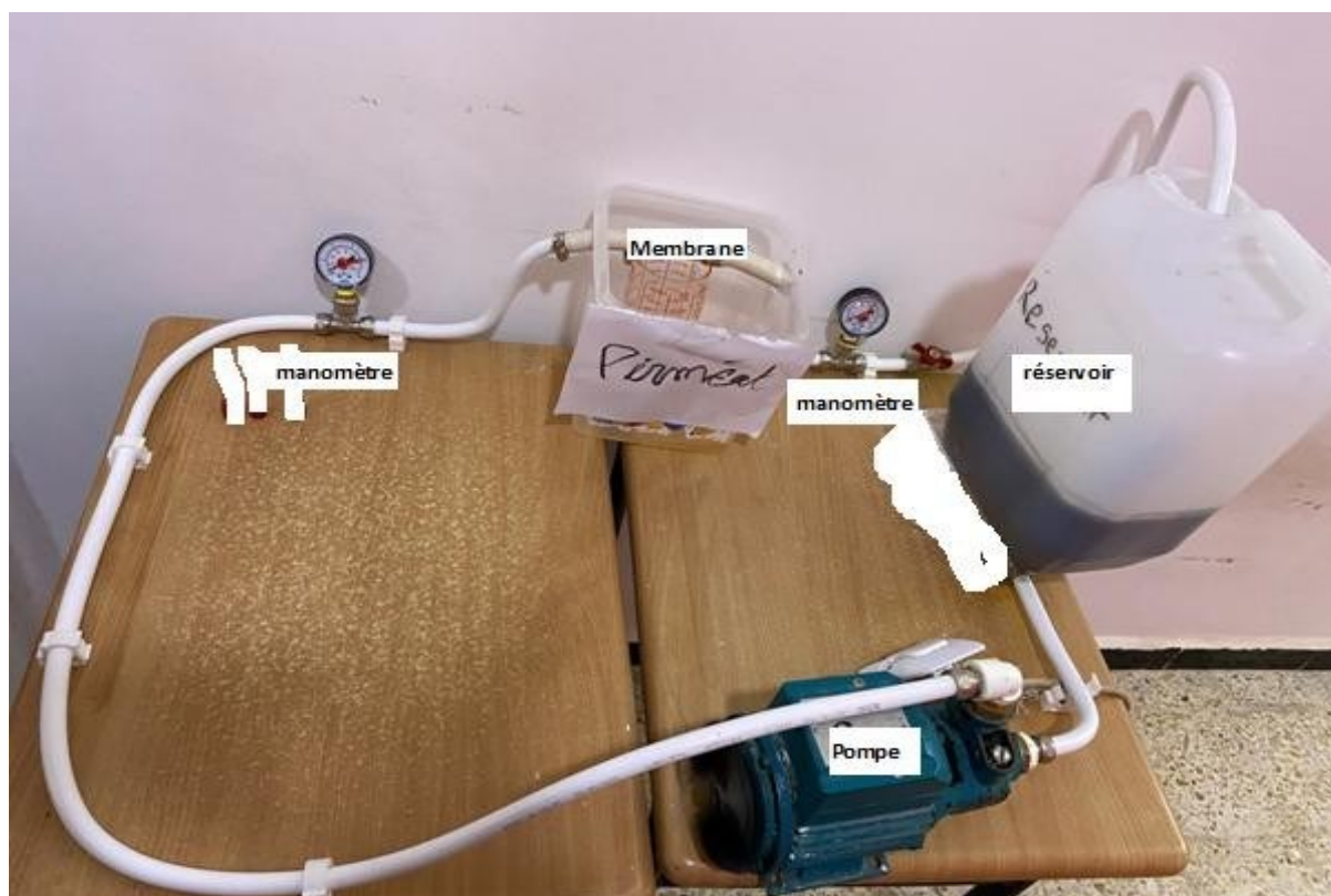
Figure IV.4- Pilote de filtration
