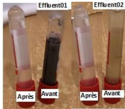
Figure IV.7-Échantillon des eaux huileuse avant et après la filtration.
