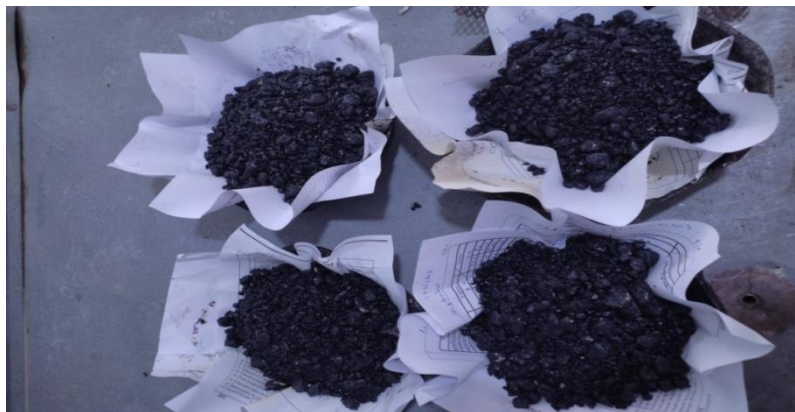
Figure V.12 : Les 4 gâchée bitumineux.
