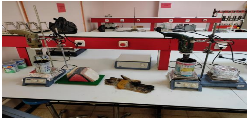
Figure IV.2 : équipement de malaxage.
