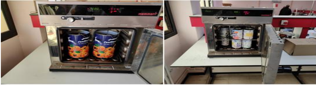
Figure IV.1 : Chauffage du bitume (a gauche) et du bitume modifié (a droite) dans le four.
