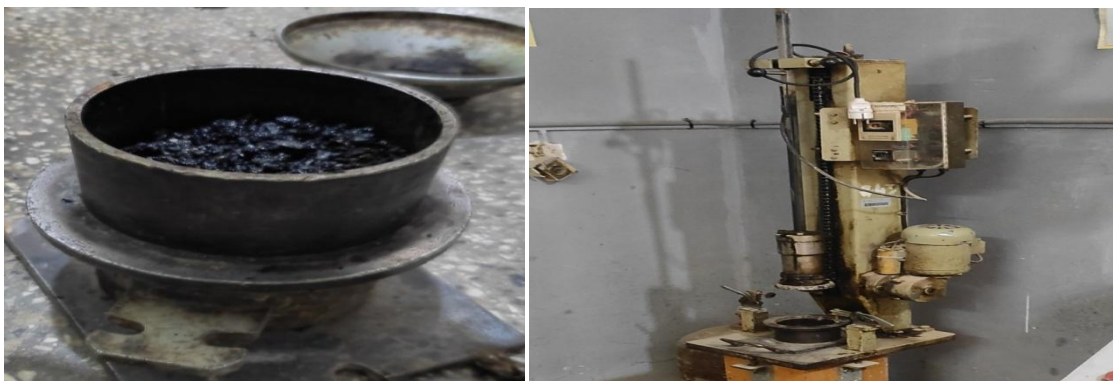
Figure V.14 : Le moule remplie et l'équipement de compactage.
