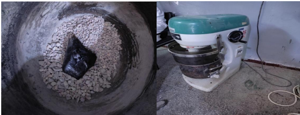
Figure V.11 : Le mélange d'enrobés bitumineux avant le malaxage et le mélangeur.
