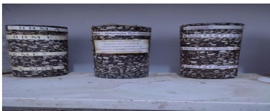
Figure III.6 : Carotte de l'autoroute Algérienne Est-Ouest.
