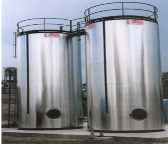
Fig. 23 – Réservoirs verticaux pour PMB
